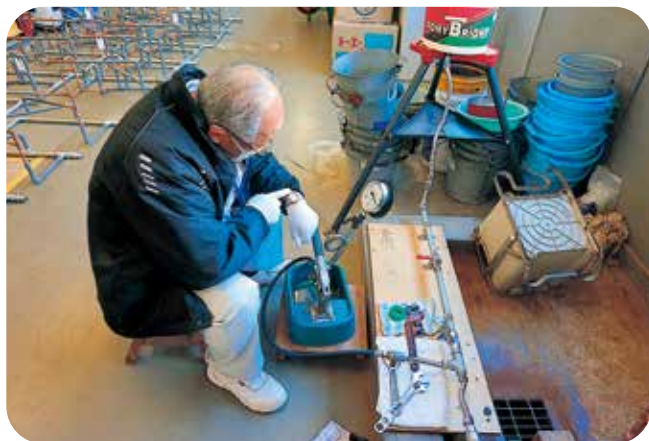
水圧検査の様子
