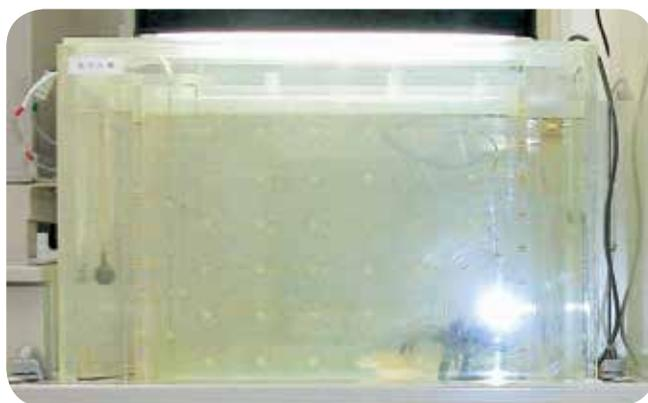
タナゴ水槽：表面にグリッドの電極が見える
